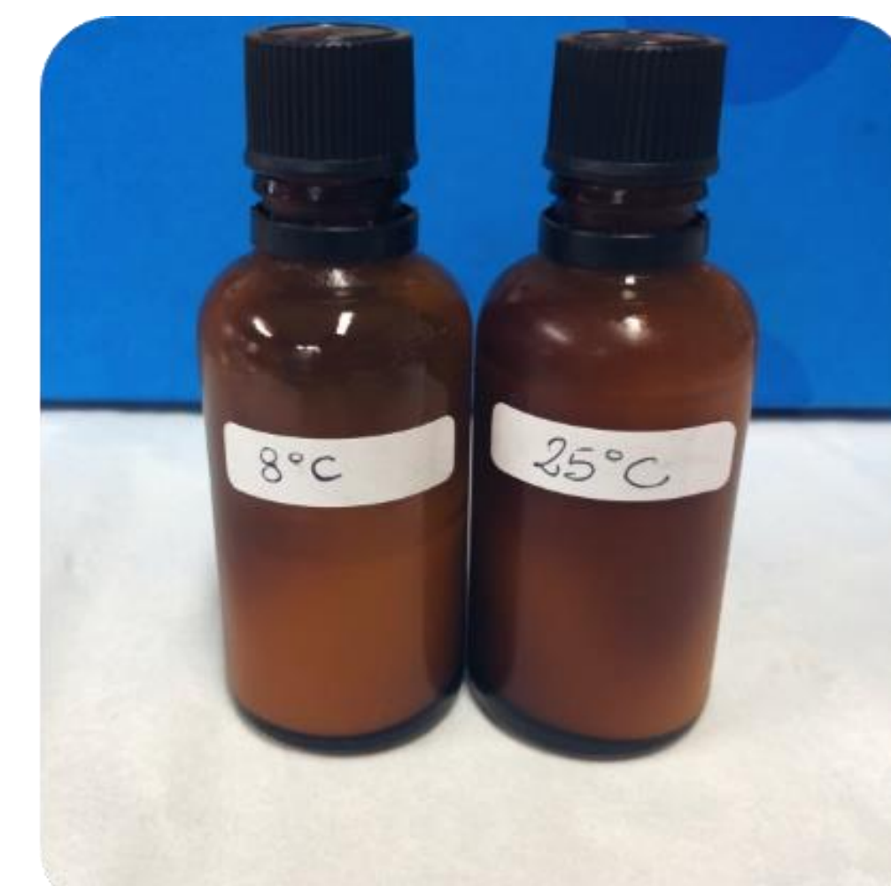
Figura 2. Campioni di soluzione di omeprazolo in fast oral solution Chopin (1,0 mg/mL) per gli studi di stabilità.
